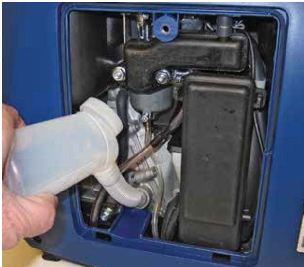
Figura 29 – Procedimiento para agregar el aceite del motor
