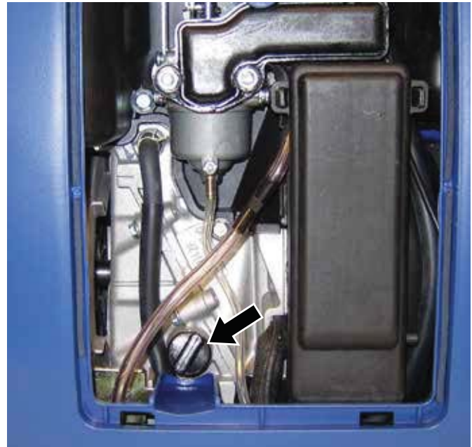
Figura 16 – Tapón de llenado/drenaje de aceite (se muestra el modelo WH1000i)
