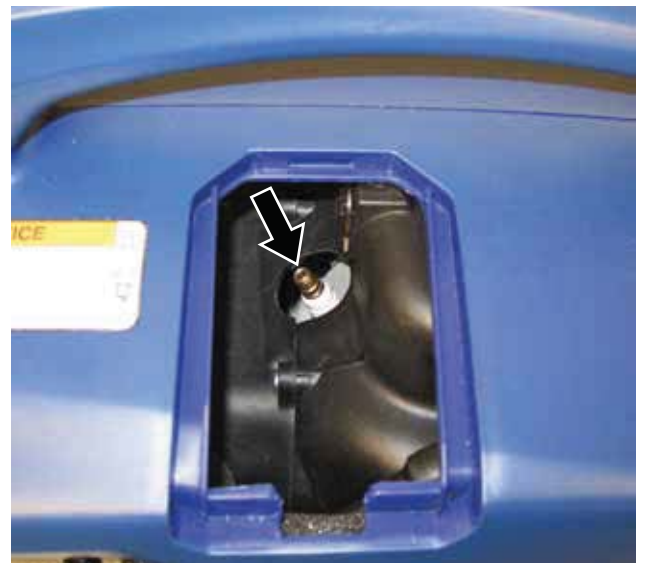
Figura 36 – Procedimiento para extraer la bujía
