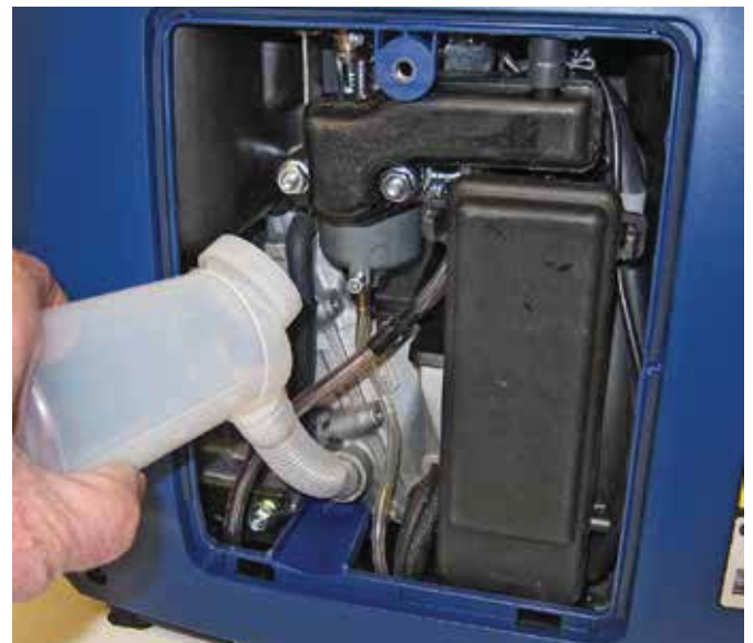
Figura 13 – Procedimiento para agregar el aceite del motor
